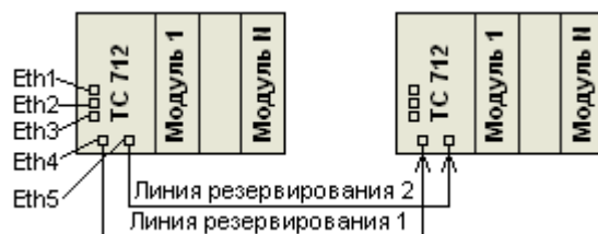
Рисунок А.2 – Структурная схема подключения модулей ЦП в системе с резервированием
